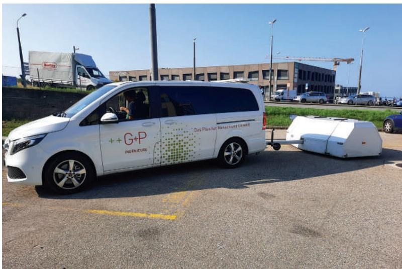
Des mesures acoustiques (méthode CPX, voir schéma ci-dessous) sur l'axe du chemin du Pré-d'Yverdon avaient été réalisées en 2021 sur un ancien revêtement routier. Cette année, une nouvelle mesure a été faite sur le revêtement phonoabsorbant récemment posé. L'objectif était de déterminer l'efficacité de ces revêtements dans une zone à vitesse limitée 30 km/h.
