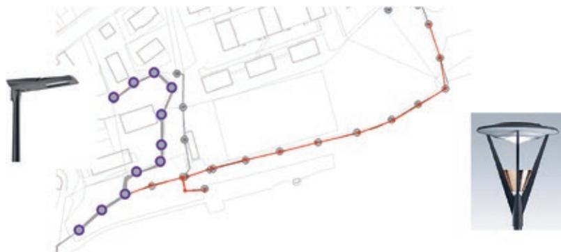
La température de couleur retenue de 2700 K diminue les impacts sur la faune sauvage à proximité de la forêt. Au niveau énergétique, la consommation annuelle passera d'environ 9758 kWh à 2369 kWh, soit une économie de 7389 kWh par année.
