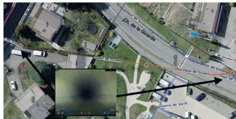
*Modification du tracé du collecteur EU sur 7 ml et pose d'une gaine thermdurcissable en polyester sur une distance de 92 ml*
