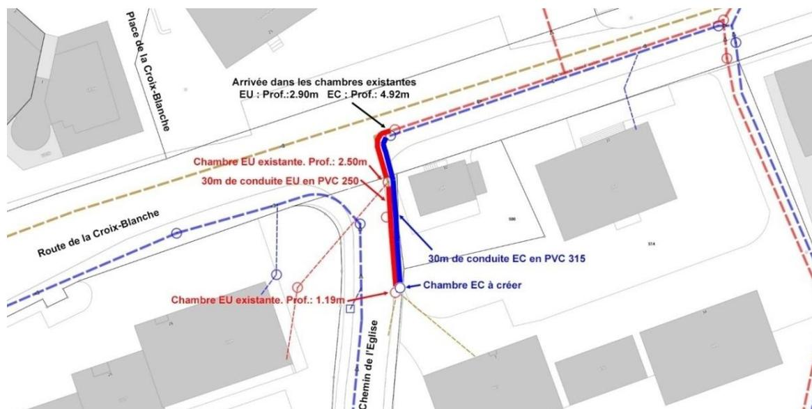
Figure 4 : Plan des travaux sur le Ch. de l'Eglise
