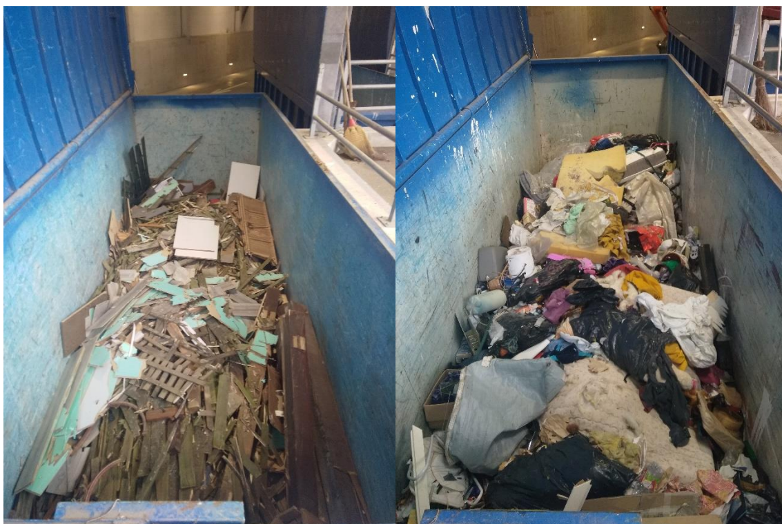
Figure 3 : Photographies après le passage du rouleau compacteur (bois à gauche et encombrants à droite)
