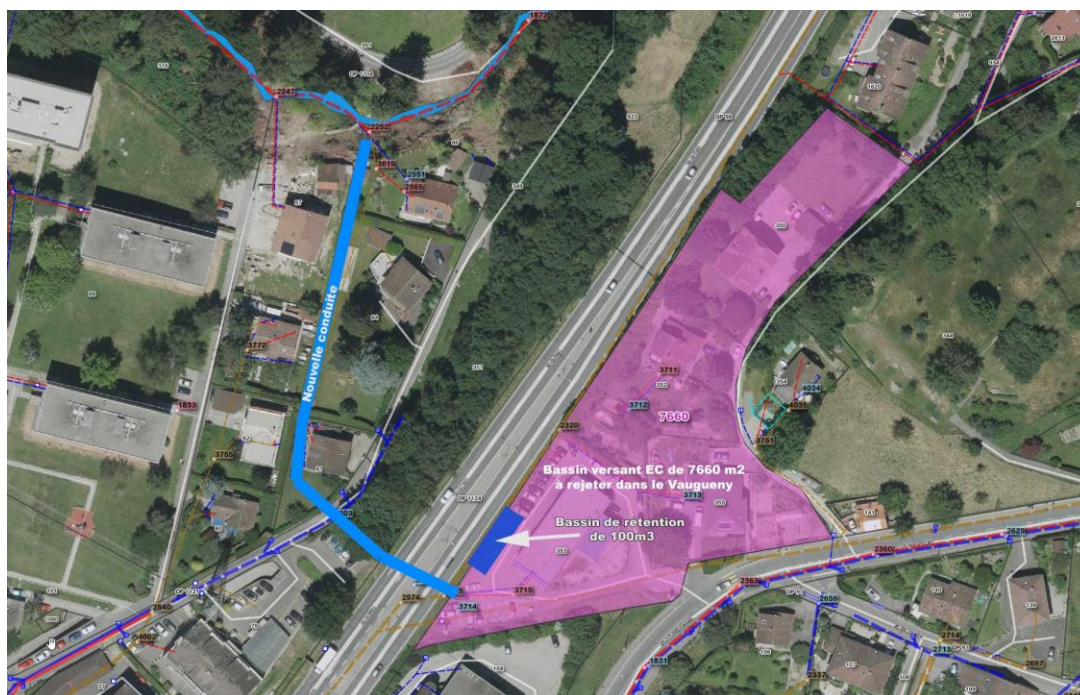
Figure 2 : Plan des travaux pour le bassin de rétention du quartier des Geais
