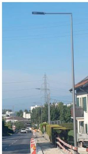
L'ancienne alimentation électrique aérienne a été mise sous tubes enterrés. Les nouveaux luminaires sont identiques à ceux installés en 2020 (Zelda X2). La température de couleur sur axe est de 4000 K.
