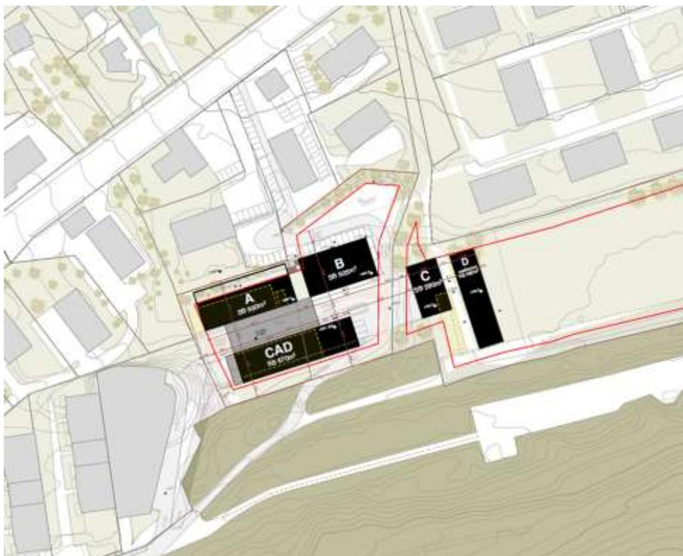
*Ci-dessus : LE CAD. A : nouvelle voirie, ateliers et bureaux. B : dépôts existants et nouveaux bureaux. C : dépôts supplémentaires. D : vestiaires (cf ci-dessous)*
